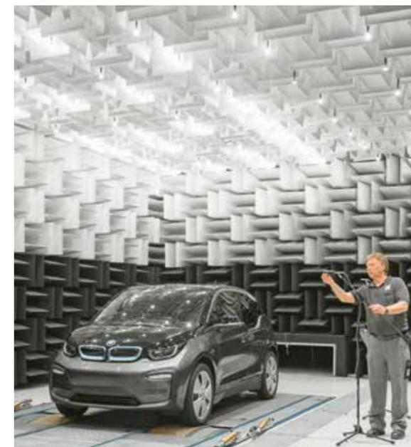
Hörbar gut: Test von Lösungen zur Reduktion von Körperschall im BMW i3 im Akustikzentrum in Worms.
