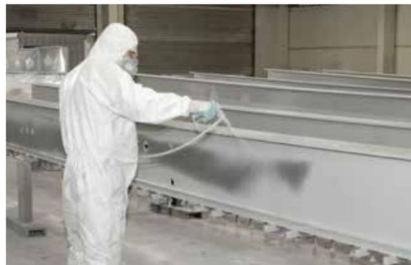
Die Sika Platinum-Technologie lässt sich direkt beim Hersteller applizieren und ist bereits nach 24 Stunden transport- und montagefähig.
