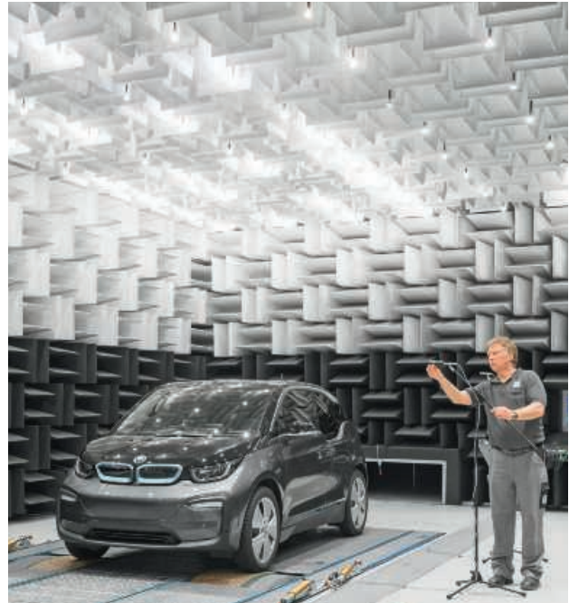
Hörbar gut: Test von Lösungen zur Reduktion von Körperschall im BMW i3 im Akustikzentrum in Worms.
