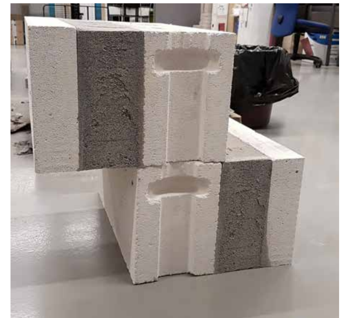
Contoh dari lapisan ganda terisolasi batu. MasterProtect NFF 2000 melindungi dinding dan memegang formwork yang menghadap tanpa penguatan.
