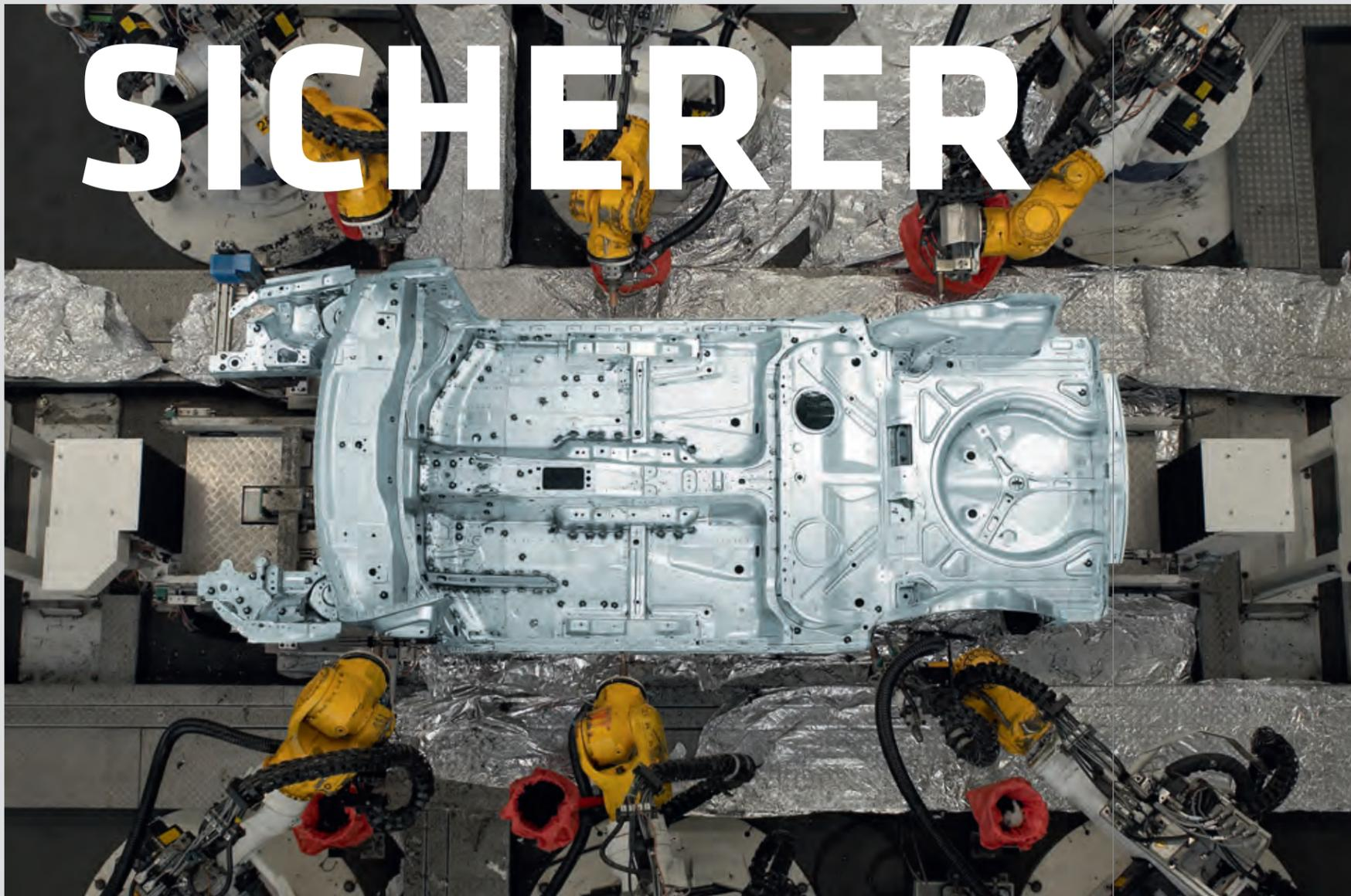
Multimaterial-Design und Modulbauweise stellen besondere Anforderungen an die Verbundtechnik, wie zum Beispiel bei der neuen Mercedes-Benz S-Klasse. Sikaflex® Montage- und Strukturklebstoffe verbinden Stahl, Aluminium, Glas und Kunststoffe. Thermoplastische Sika-Reinforcer® Bauteile verbessern Fahrzeugsteifigkeit und Akustik, und SikaPower® steigert die Crashfestigkeit. Aus diesem Grund setzt Mercedes-Benz auch bei der S-Klasse Sika Klebstofflösungen ein.
