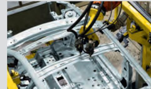
Mehr Komfort dank Sika: Sika Technologien tragen zur Versteifung der Karosserien und damit zur Verbesserung des Fahrverhaltens und der Geräuschdämmung im Innenraum bei.
