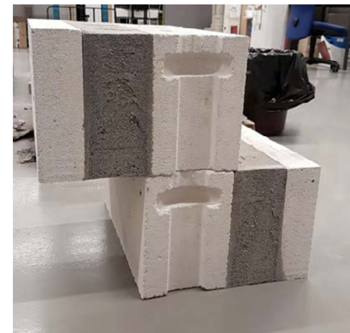
断熱二層石材の例。MasterProtect NFF 2000 IN は壁を断熱し、補強なしで表面型枠を保持します。
