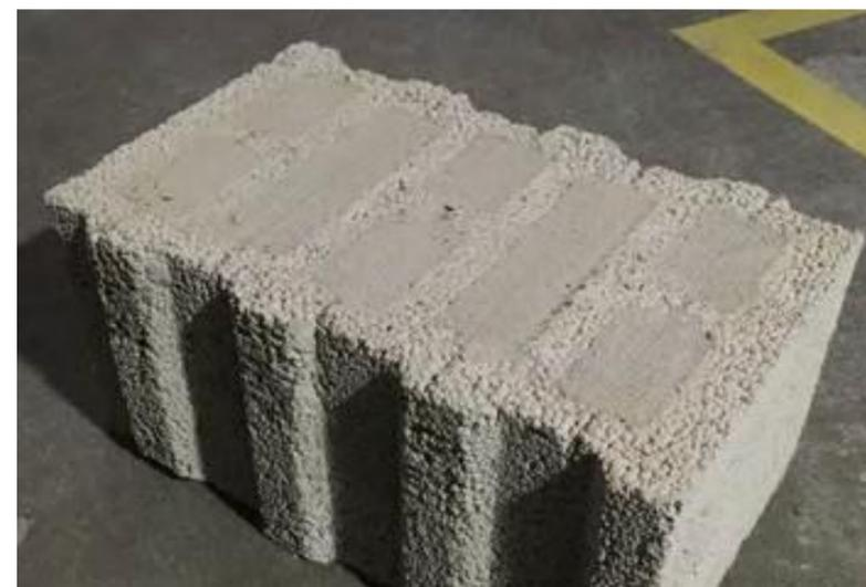
Ví dụ về khối bê tông được đổ đầy với bọt cách điện 35 mW / m<sup>2</sup>K
